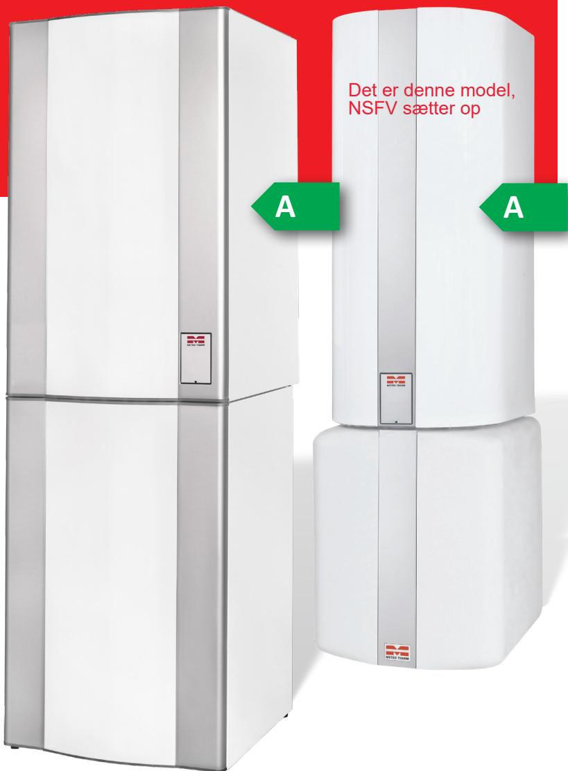
METRO System 5 er en fuldisoleret fjernvarmeunit med brugs-vandsopvarming via beholder samt opvarmning af radiatorkredsen med fremløbstemperaturregulering. Styring af rumopvarmingen sker via en ECL 110 med vejrkompensering. Tilslutninger er DN20.
